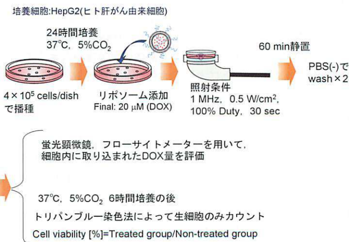
図 2. 細胞に取り込まれたドキソルビシン量を評価する実験 ならびに、細胞傷害を評価する実験の手順
