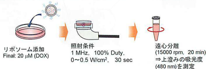
図 1. 超音波照射によりドキソルビシン放出率を評価する実験の手順
