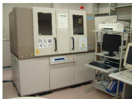
図1 X線回折装置（システム2）の外観
