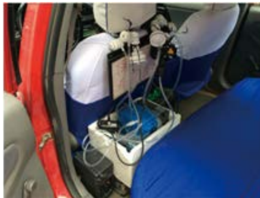
図1 タクシー車内に設置した捕集装置類
