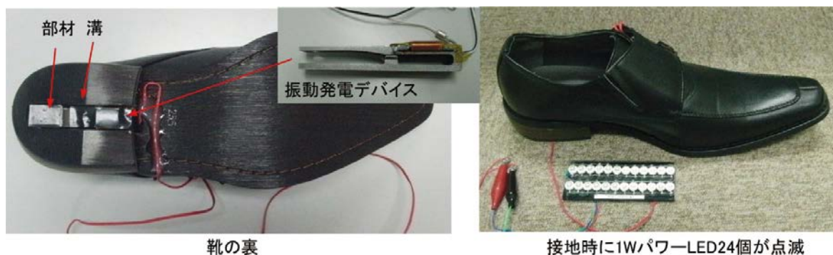
試作した靴の写真：デバイス搭載の様子（左）と発電のデモ（右） 発電の動画： http://vibpower.w3.kanazawa-u.ac.jp/power_shoes.html
