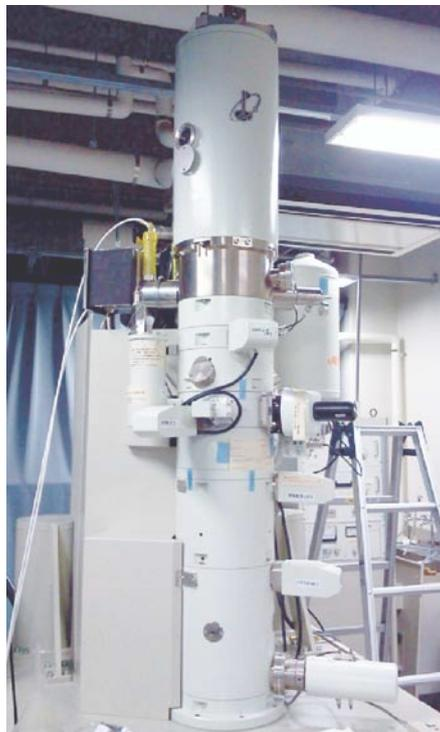
図 1 FE-TEM の外観 (電子銃部, 鏡筒部)
