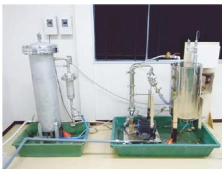
図1 耐火石水製造装置
