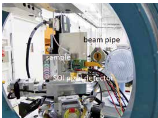
図1 放射光施設 SPring-8 における超高速 X 線残留応力測定のセットアップ (左) および高応力標準片 (-443 ± 35MPa) の測定結果 (右) [引用: S. Mitsui, et. al., Development of Debye-ring measurement system using SOI pixel detector, Nucl. Inst. and Meth. A]
