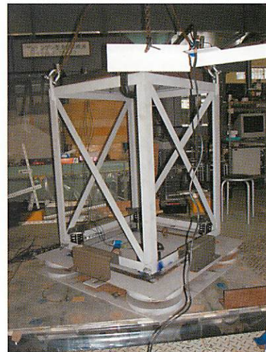
写真 - 2 自動販売機に対する免震台座振動実験
