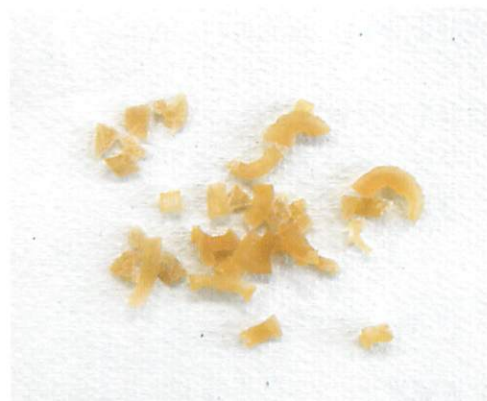
写真： 重金属廃液処理後、乾燥したものの。体積が小さくなり管理が容易になった。
