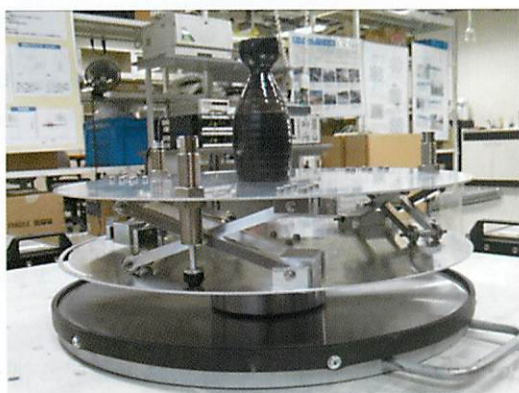
写真 - 1 美術工芸品に対する免震台座の試作品
